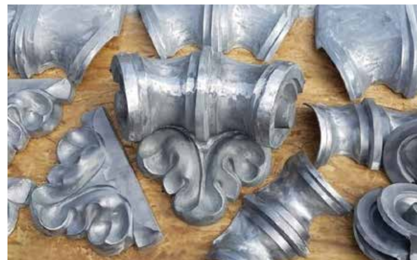
19. kép | Megformázott, majd újraöntött bádogos díszek, Füleky Zsolt felvétele
