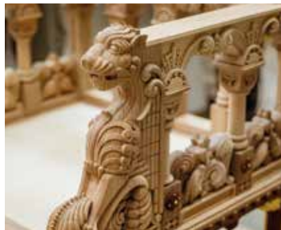
7. kép | A 3D- és a CNC-technológiával történő megmunkálást követően a faragás utolsó, legnagyobb odafigyelést igénylő munkafázisai kézzel készültek / Várkapitányság, fotó: Kárász Karolina
